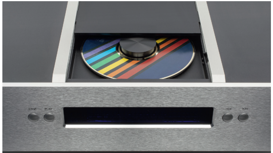
GANZ SCHÖN TRÄGE: Der massive Magnet-Clip hält die CD sicher auf der Spindel, lässt sie aber nach Öffnen der Luke nachlaufen.
